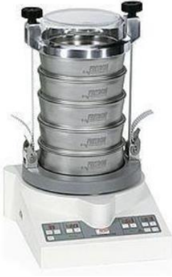
Şekil 4.5.2 Otomatik eleme cihazı ve elekler [5]
